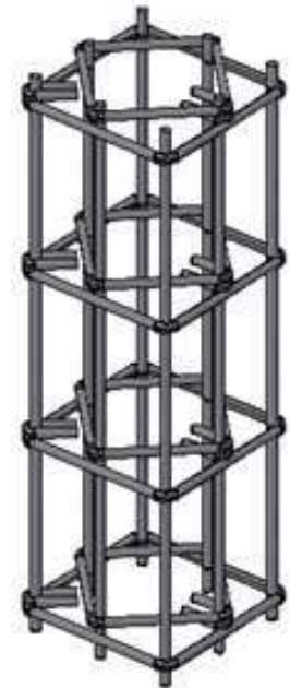
(d) Sengkang gabungan konfigurasi biasa dan diamon
