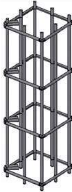
(b) Sengkang konfigurasi sederhana/bulat
