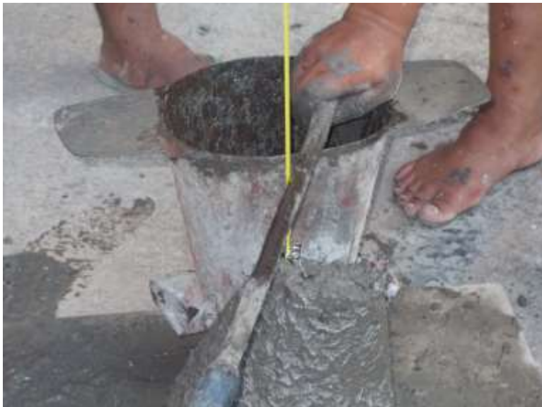
Pengukuran nilai slump
