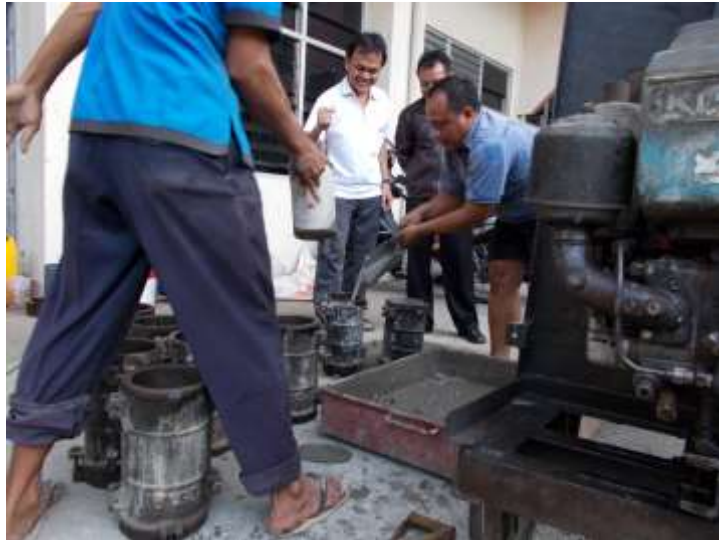
Penuangan adukan beton ke cetakan
