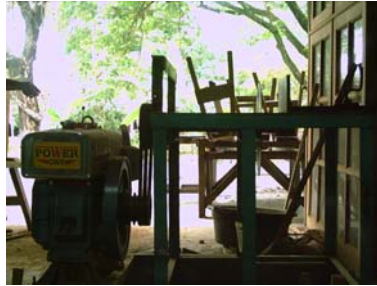
Gambar 4.6c. Tampak depan Gambar 4.6 Mata pisau gergaji digerakan mesin diesel
