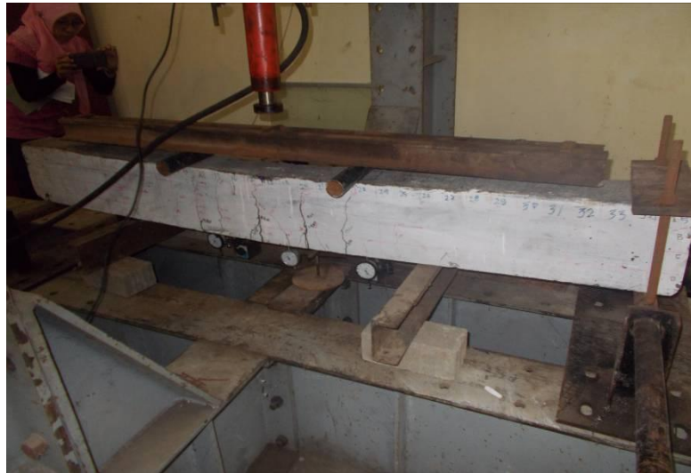
Gambar 3. Keruntuhan lentur hasil eksperimen
