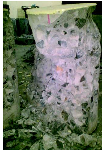
Gambar 1. Keruntuhan beton pasir Kuarsa
