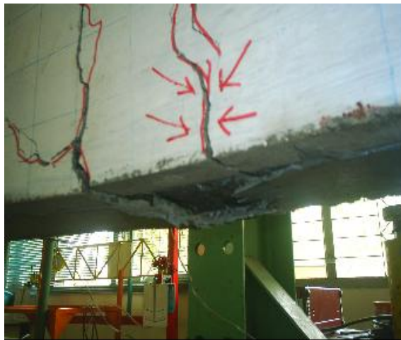
Gambar 6b. Foto pola retak spesimen BCW-1/2b
