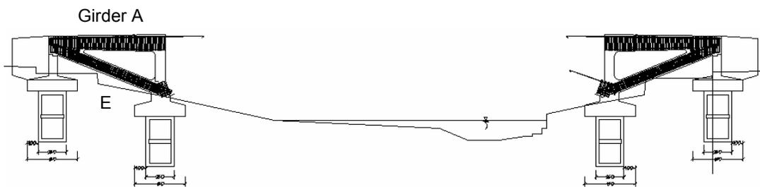
**Tahap 4:** Sebelum tahap selanjutnya dimulai, terlebih dahulu dibuat rangka baja kantilever dengan penggantung kabel sebagai pengait bekisting. Selanjutnya hadala pembuatan girder B dengan menggunakan bekisting dari kantilever rangka baja tersebut pada sisi kanan dan kiri.
