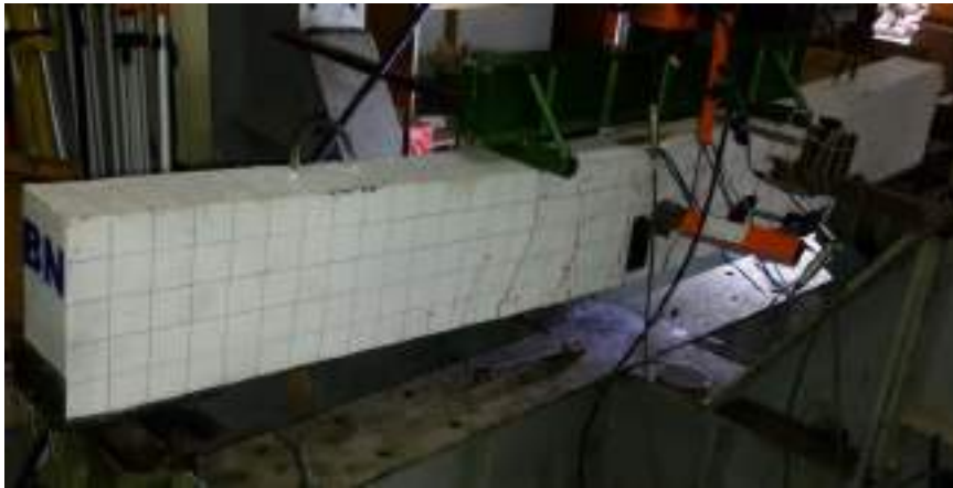
Gambar 3.5. Eksperimen balok dengan sistim two point load
