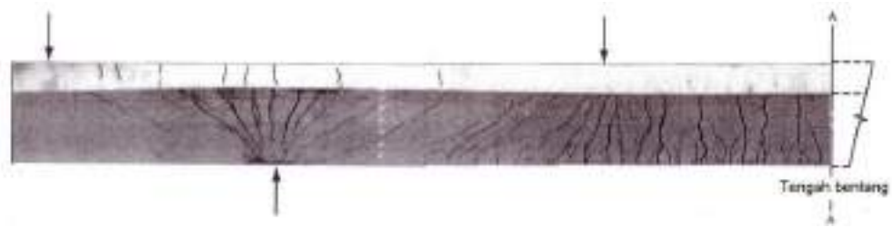
Gambar 4.4. Hasil eksperimen pada balok T (MacGregor, 1997)
