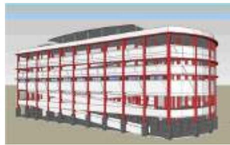
Gambar 12.8. Konfigurasi struktur gedung beraturan arah horizontal dan vertikal
