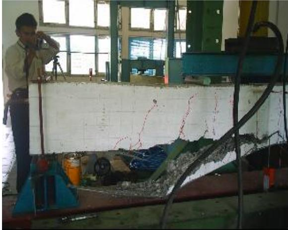
Gambar 7b. Foto pola retak spesimen BCW-b
