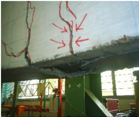
Gambar 6b. Foto pola retak spesimen BCW-1/2b
