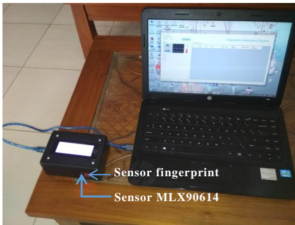
Gambar 8. Sistem monitoring suhu dan kehadiran siswa
